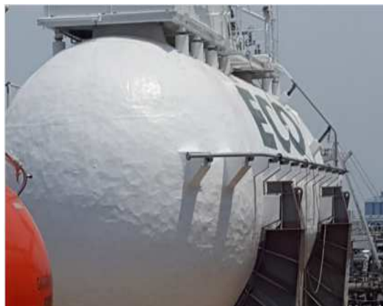
極低温保冷材を利用した燃料タンク
