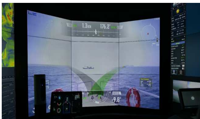
大宇造船海洋 R&D キャンパス内の自律運航船陸上管制センター
